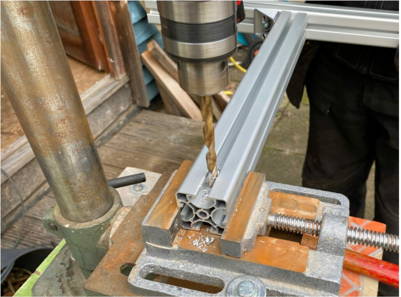
Dadurch wird das waagerechte, kurze Profil verschiebbar sein und der Winkel des Gestells kann variiert werden. Mit 8er Schrauben und Nutensteinen wird das Gestell verschraubt.
